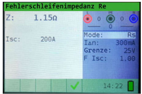
Abb. 16: Messung der Fehlerschleifenimpedanz mit einstellbarem FI, Kabelanschluss und Ergebnisse
