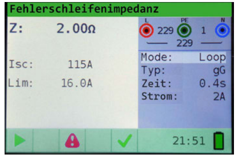
Abb. 14: Messung der Fehlerschleifenimpedanz, Kabelanschluss und Ergebnisse
