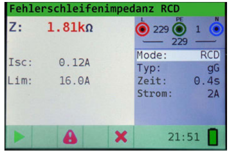
Abb. 15: Messung der Fehlerschleifenimpedanz mit FI, Kabelanschluss und Ergebnisse
